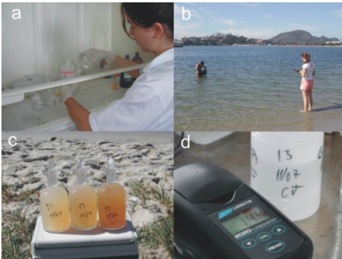
Figura 3 – Limpeza de vidraria para análises de oxigênio dissolvido (a); leitura de parâmetros físico- químicos in situ (b); fixação de oxigênio in situ (c); leitura de turbidez em laboratório (d).
