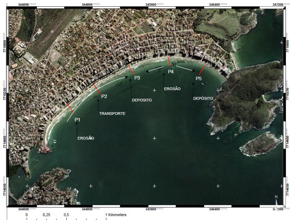
Figura 25: Direção do transporte sedimentar para inverno de 2009, de acordo com modelo Taggart e Schwartz adaptado.
