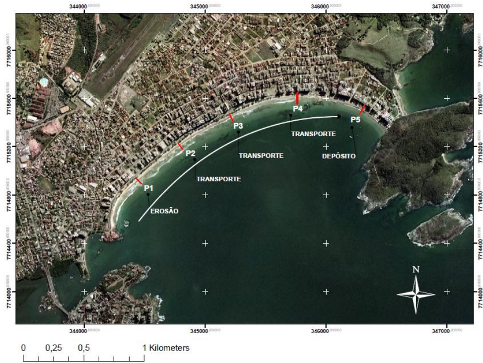
Figura 24: Direção do transporte sedimentar para verão de 2009, de acordo com modelo Taggart e Schwartz adaptado.
