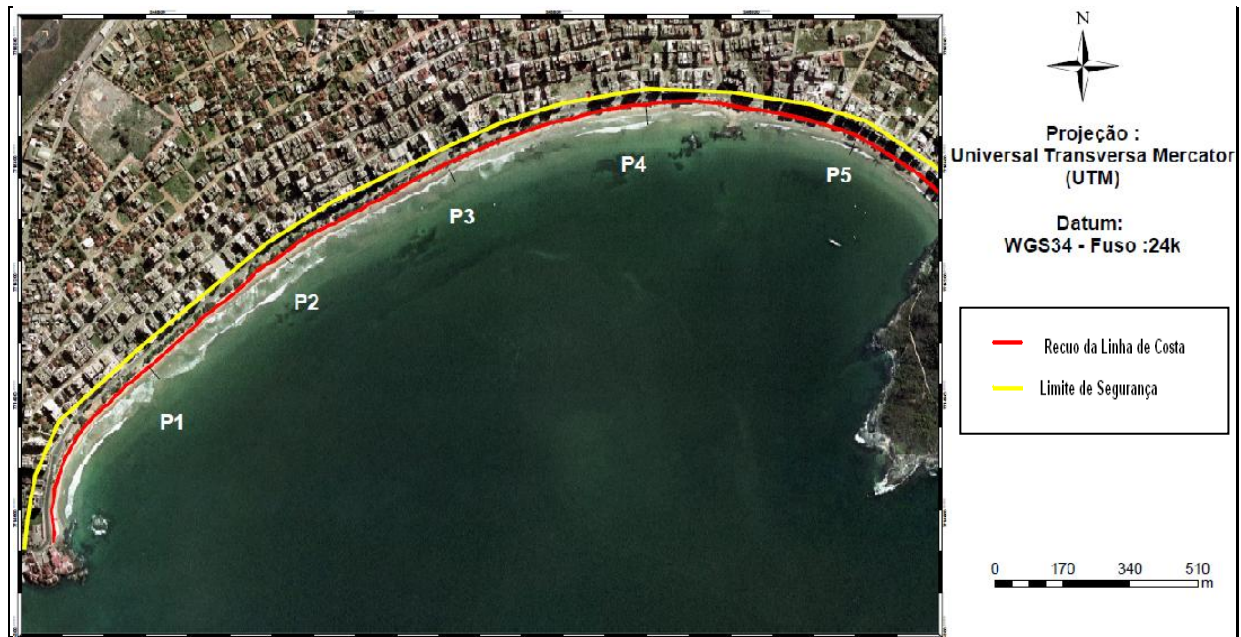
Figura 28 :Delimitação do recuo da linha de costa a uma elevação do nível do mar (vermelho) e faixa de segurança proposta por Muehe, 2001, (amarelo).
